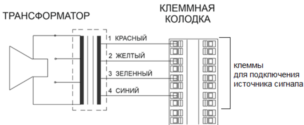
Рисунок 7 – Схема подключения AR-25Ex
